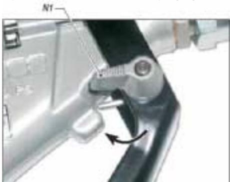
Для разблокирования скобы подачи материала поверните флажок N1 предохранителя от корпуса пистолета
